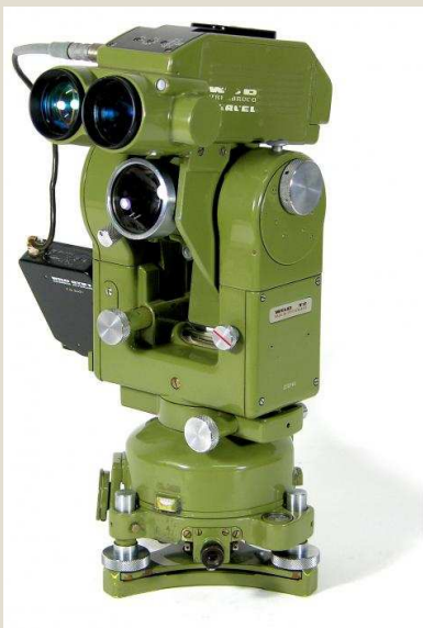
Figura 1.15 – Teodolito Wild T2 e distanciômetro eletrônico acoplado. Fonte: http://www.dehilster.info/geodetic_instruments/1976-1979-wild-t2-mod-di4.php
