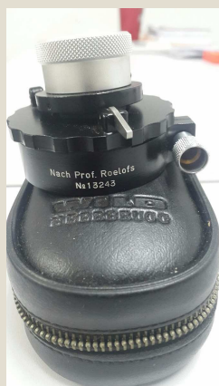
Figura 1.13- Prisma de Roelofs. Fonte: https://produto.mercadolivre.com.br/MLB-687932402-prisma-solar-de-roelofs-_JM e http://www.wild-heerbrugg.com/shop/product_info.php?products_id=469
