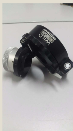
Figura 1.13- Prisma de Roelofs. Fonte: https://produto.mercadolivre.com.br/MLB-687932402-prisma-solar-de-roelofs-_JM e http://www.wild-heerbrugg.com/shop/product_info.php?products_id=469
