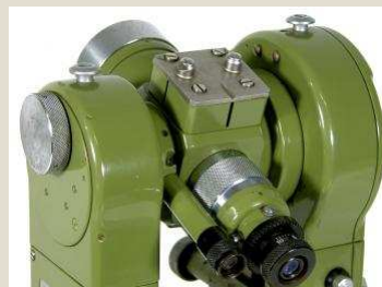
Figura 1.16 – Adaptação para o distanciômetro eletrônico. Fonte: http://www.dehilster.info/geodetic_instruments/1976-1979-wild-t2-mod-di4.php .
