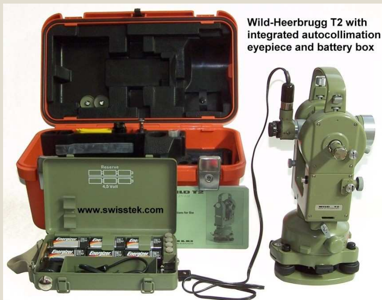
Figura 1.12 - Teodolito Wild T2 e sistema de iluminação. Fonte: http://opticaltooling.tripod.com/
