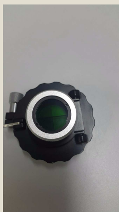
Figura 1.13- Prisma de Roelofs. Fonte: https://produto.mercadolivre.com.br/MLB-687932402-prisma-solar-de-roelofs-_JM e http://www.wild-heerbrugg.com/shop/product_info.php?products_id=469
