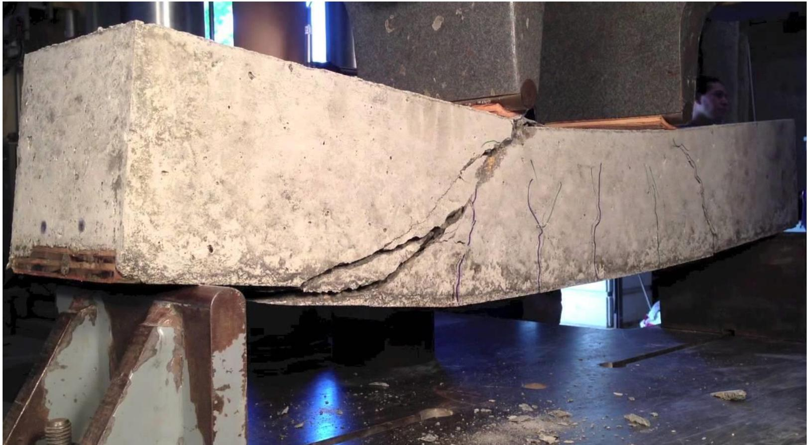
Entre as bordas comprimida e tracionada existe uma camada cujas fibras não sofrem variação alguma de comprimento, não estão sob tensão; a linha baricêntrica (centro de gravidade da seção transversal) desta superfície é denominada de **linha neutra** (interseção do plano da seção transversal com o plano das camadas neutras).
